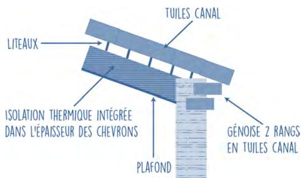
**Détail rénovation d'une toiture avec isolation thermique intégrée maintenant l'aspect de la génoise**
