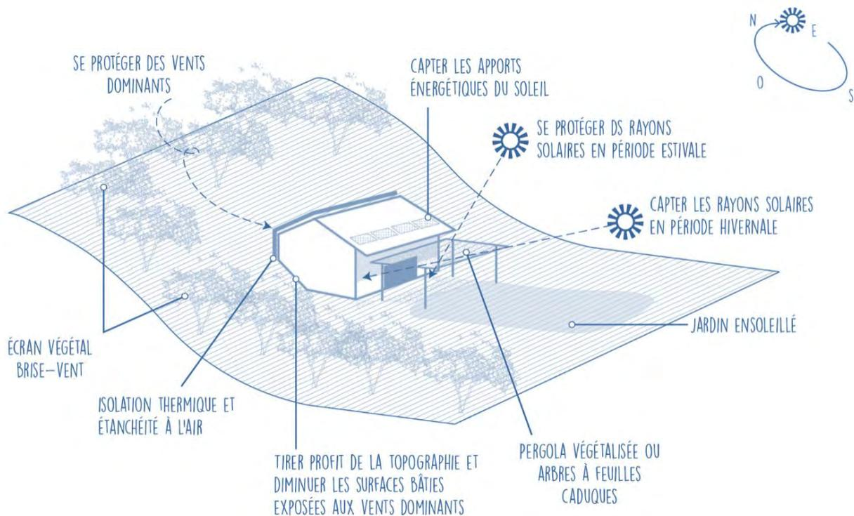
**Principes d'orientation bioclimatique des constructions – Source : AURCA**
