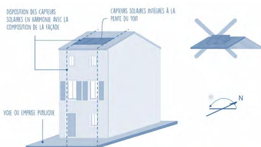
Principe d'intégration des capteurs d'énergie solaire – Source : AURCA
