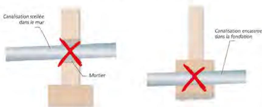
**Conditions de mise en œuvre :** Les canalisations seront réalisées avec des matériaux non fragiles (c'est-à-dire susceptibles de subir des déformations sans rupture). Elles seront aussi flexibles que possibles, de façon à supporter sans dommage les mouvements du sol.
